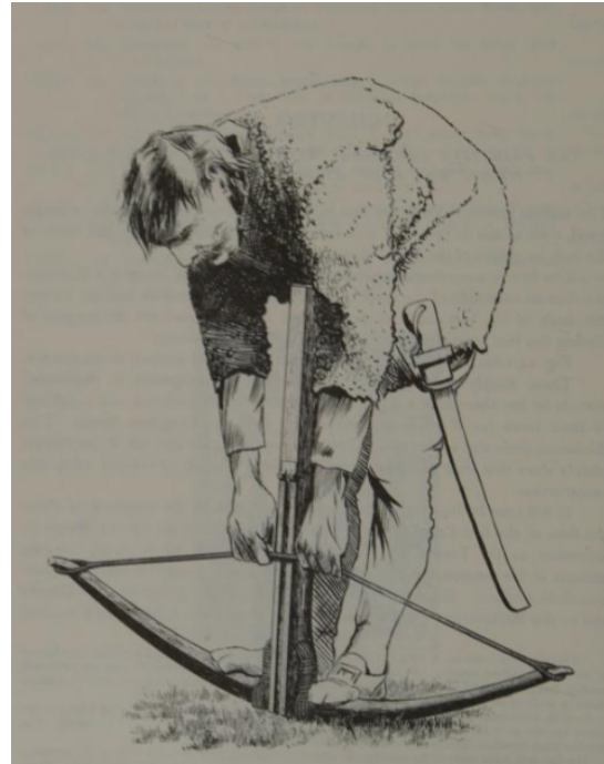
Figure n° 9 : Représentation de la méthode de chargement d'une détente européenne dite primitive © R. PAYNE-GALLWEY, The Crossbow... , op. cit. , fig. 24.
